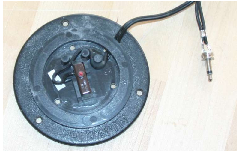
Hier: Gelbe Kappe abmontiert. Das braune Teil in der Mitte ist der eigentliche Taster
